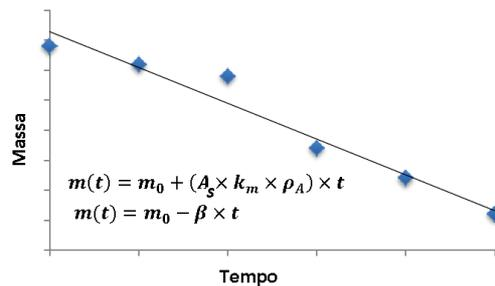
Figura 0.1: Comportamento experimental esperado.
